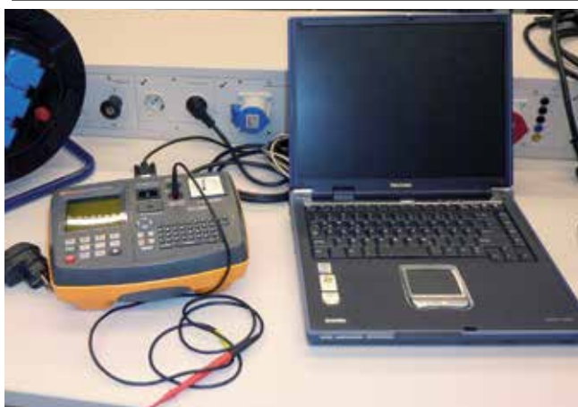
Bild 5-36: Prüfanordnung (Prüfgerät, PC) zum rechnergestützten Messablauf und Erfassung der Messdaten
