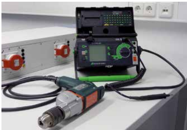
Bild 5-35: Prüfgerät für die Prüfung ortsveränderlicher elektrischer Betriebsmittel
