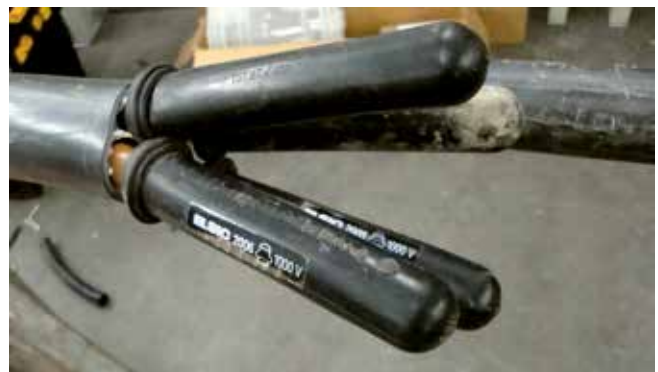
Bild 5-5: Isolierkappen zum Abdecken von Isolatoren
