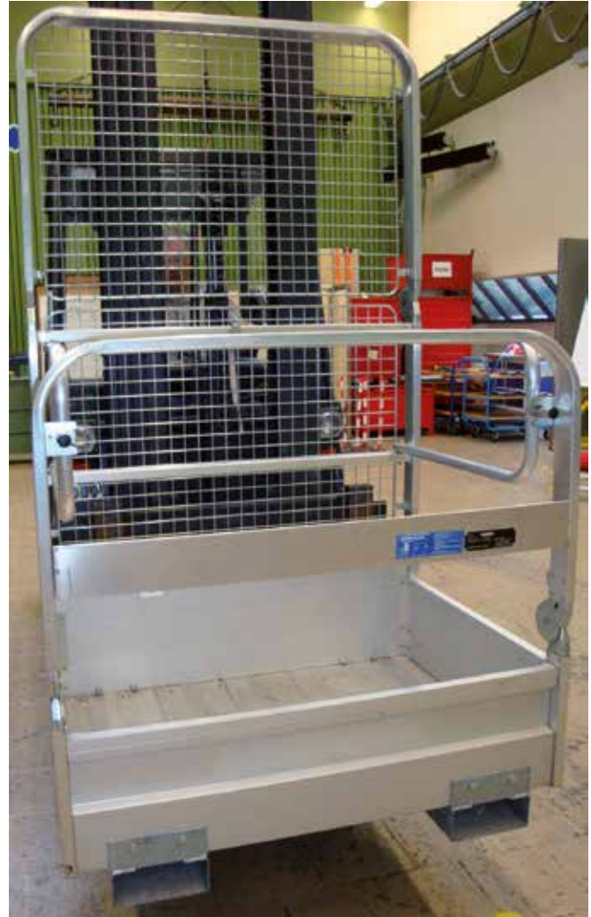
Bild 6-2: Beispiel einer Arbeitsbühne für Gabelstapler
