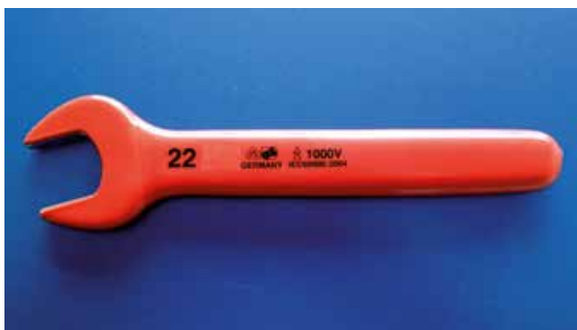
Bild 5-6: Vollisolierter Einmaulschlüssel für Arbeiten bis 1000 V
